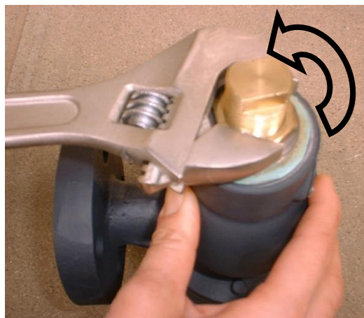
3.キャップ⑪を取り外すとロックナット⑩が確認できます。ロックナット⑩を反時計回りさせて緩めてください。モンキーレンチ等(口巾 30mm)で緩めます。
