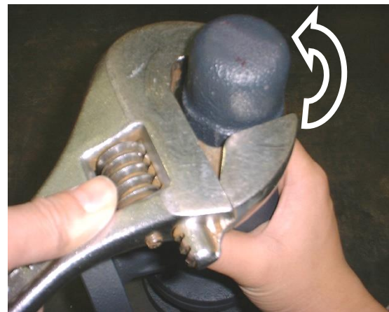
2.キャップ⑪は二面部にモンキーレンチ(口巾 60mm)を掛け反時計周りに回し取り外します。
