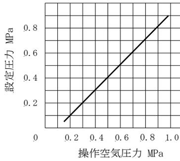
GP-1200T, 1210Tでの操作空気圧力に対する設定圧力は、基本的に左図のようになります。(一次側圧力が 1.0MPa の時)
