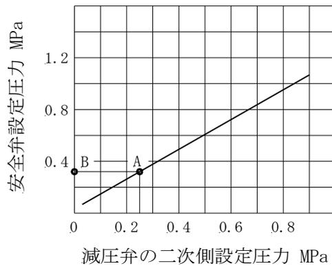
減圧弁の二次側設定圧力を定め、線図との交点(A)を求め、(A)点より水平にたどった(B)点の圧力以上を安全弁の設定圧力とします。
