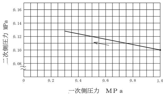
一次側圧力 1.0 MPa に対して二次側圧力を 0.1 MPa に設定して、一次側圧力を 1.0 $\pm$ 0.3 MPa に変化させた時の二次側圧力の変動値を示します。
