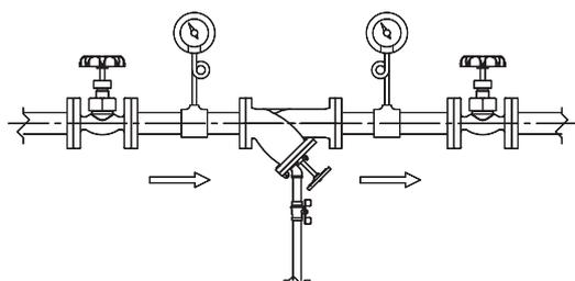
配管図例2.垂直配管(SY-40R-B)
